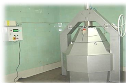
Fig. 2. Irradiador autoblindado, modelo “ISOGAMMA LLCo”
