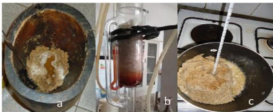
**Fig. 2. Processos de extração de oleos: a) prensa a frio e b) soxhlet; c) cozimento do material vegetal**
