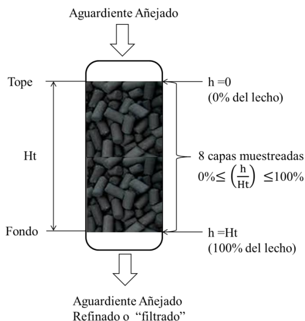
Fig. 1- Diagrama general del adsorbedor en lecho de cama fija y proceso de muestreo
