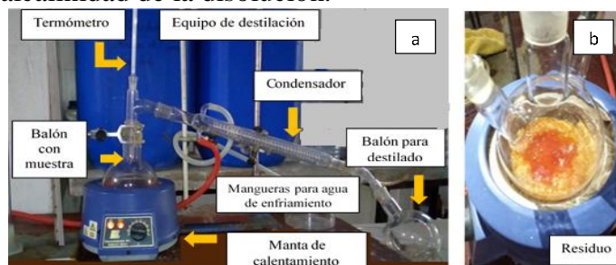
Fig. 2- Equipo de destilación usado para recuperar el etanol (a) y residuo obtenido (b)
