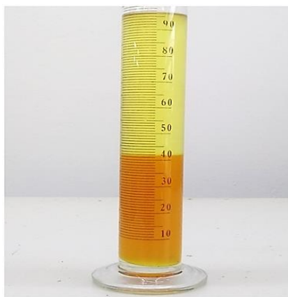
Fig. 1- Separación bifásica en la extracción de Bligh-Dyer del subproducto de lecitina de soya: metanólica-acuosa (superior) y clorofórmica (inferior)
