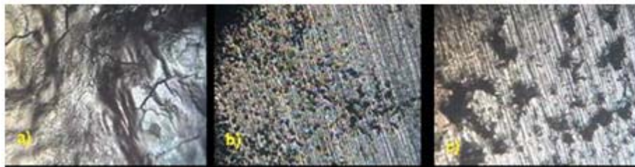
Foto 1. Micrografía del acero del ducto en el agua de capa a 35 °C en diferentes aumentos: a) 50X, b) 50X, c) 200X.
