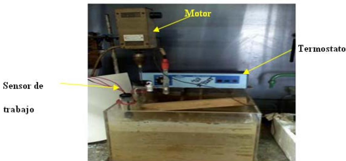
Fig. 1 Montaje de laboratorio para ensayo electroquímico.
